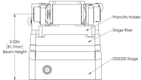
**Figure 6 DDS220(/M) Beam Entrance Height**
